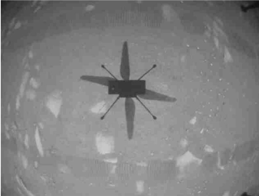
**E**l helicóptero Ingenuity tomó esta foto mientras flotaba sobre la superficie marciana el 19 de abril de 2021, durante la primera instancia de vuelo controlado y con motor en otro planeta. Usó su cámara de navegación, que rastrea de forma autónoma el suelo durante el vuelo. En el lateral, una ampliación que resalta detalles del suelo marciano debajo de la sombra. [NASA/JPL-Caltech]
